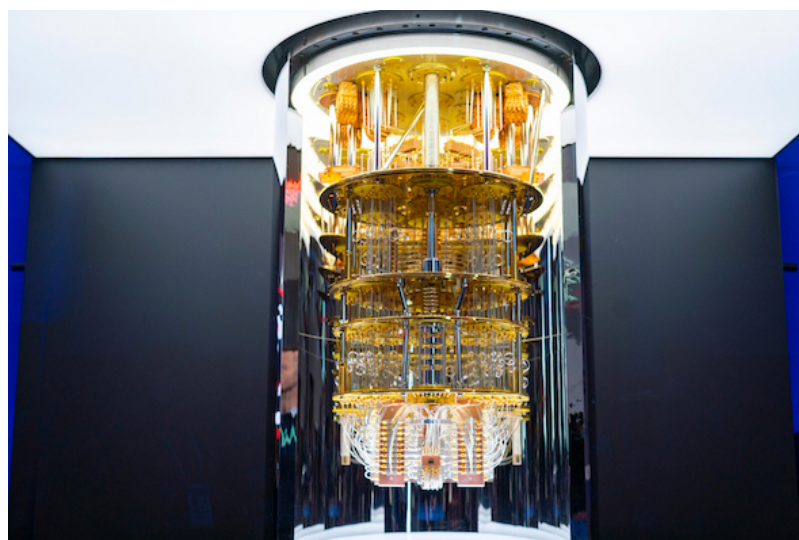
図 2.2 IBM による量子ゲート方式のマシン「IBM Q」 *3
