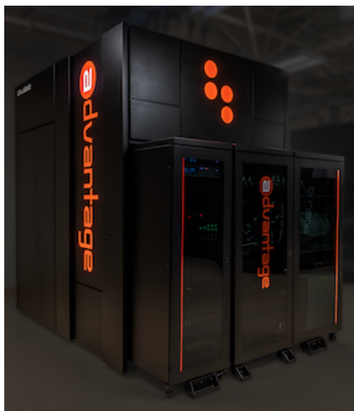
図 2.4 D-Wave Systems による量子アニーリング方式のマシン「D-Wave Advantage」*5
